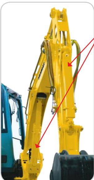
> Cilindros totalmente protegidos (varilla y cilindro) con placas de acero de gran elasticidad para resistir posibles golpes.
