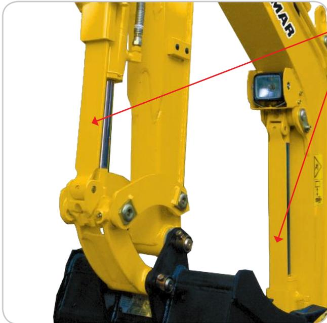
Todos los cilindros del brazo están totalmente protegidos con placas de acero de gran elasticidad para resistir posibles golpes.
