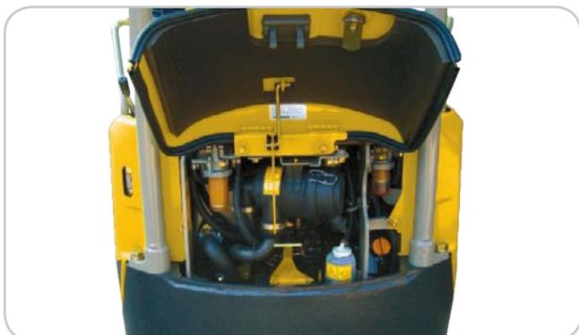
> Acceso fácil a los diversos puntos de mantenimiento: órganos del motor, bombas hidráulicas,...
